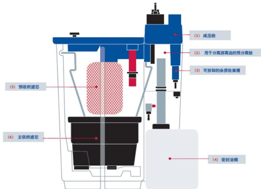
含油冷凝液通过减压舱进入预分离舱后，压力得到释放。在预分离舱内，油滴在液面上形成油膜后流入收集油桶。经过预净化后的冷凝液通过预吸附和主吸附滤芯对漂浮的残油进行吸附，吸附后的水可直接排放到下水系统中。
