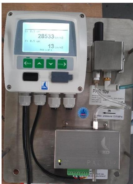
通过德国贝克欧科技公司METPOINT OCV和METPOINT PAC，可以在线测量压缩空气含油量和颗粒，直观反映空压机、干燥机、过滤器的使用效果，对设备设计、维护和保养提供了依据。
